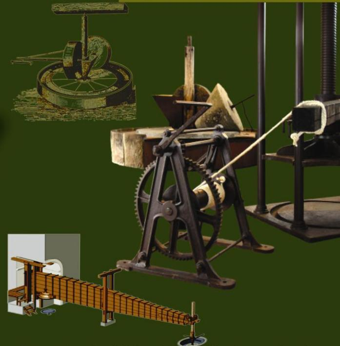
Se muestran los distintos sistemas utilizados para la molturación y extracción del aceite de oliva. Encontramos piezas originales de sistemas de extracción tradicional y maquetas de distintos tipos de prensas.
